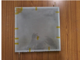
FIG. 2: Complete RPC module.
