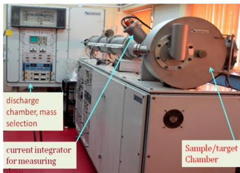
Fig. 2 Photograph of ion implanter (Danfysik 1080-30).
