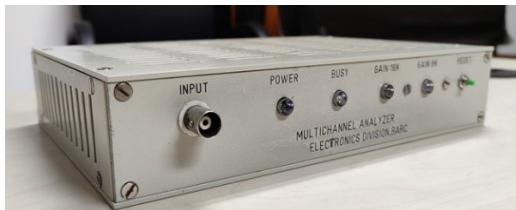
Fig. 1 16k bench-top Compact MCA module
